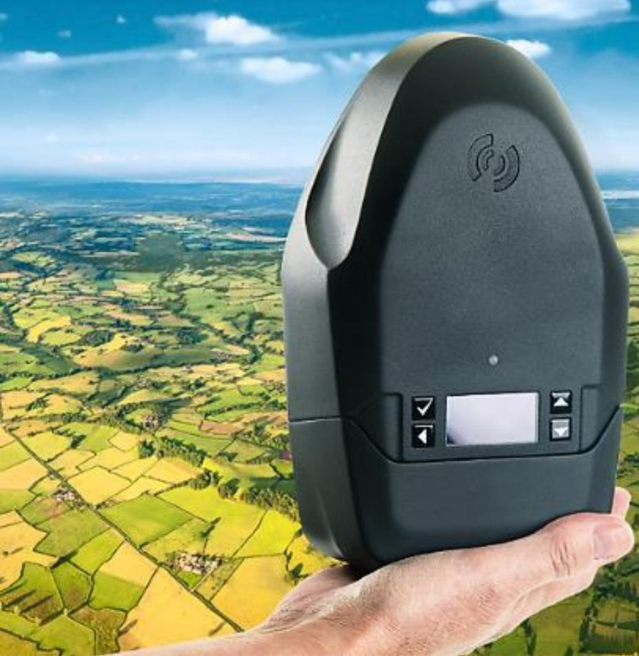
HSC-2ハイパースペクトルカメラは世界最小のハイパースペクトルフレームカメラです。このHSC-2は、1回の撮影で可視-近赤外のスペクトル画像を最大1,000バンド、撮影可能で写真測量ソフトウェア（Agisoft Metashape Professional等）でモザイク処理が可能です。HSC-2ハイパースペクトルカメラは、ドローンをはじめ様々なプラットフォームに搭載されており、特に農業、林業、水質調査用のUAVに搭載している実績があります。
