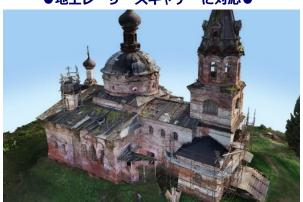
これまでのカメラで撮影された画像に加えて、地上のレーザースキャナーデータ(LiDAR)をシームレスに統合して、あらゆる写真測量ソフトウェアツールをLiDARデータに適用することが可能です。
