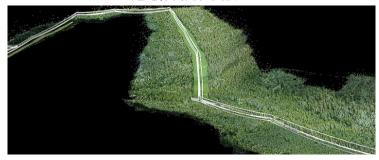
画像上の送電線を自動的に検出する機能が追加されました。各電線の3Dポリラインモデルは文書化や分析のためにエクスポートしたり、Metashape内のミッションプランニングで障害物回避のために使用することができます。
